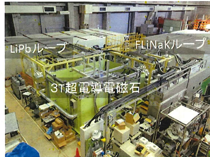
国内にある溶融塩ループの例 （核融合科学研究所施設*）
